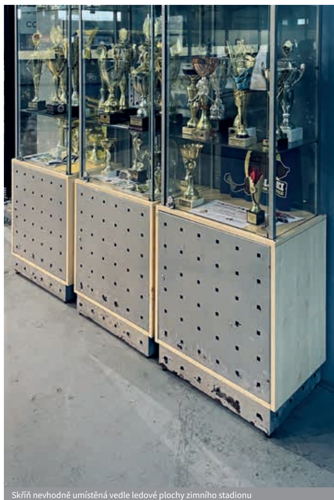
Skříň nevhodně umístěná vedle ledové plochy zimního stadionu
